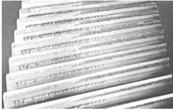
Figura 1.6 Falla por agarramiento
