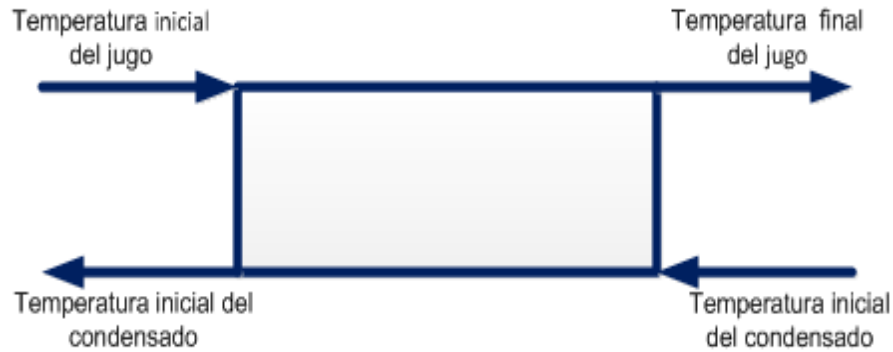
Figura 3.1 Esquema de análisis calentador L – L. (Fuente de elaboración propia del autor)
