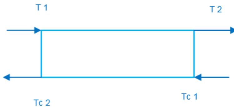
Figura II.3 Esquema del calentador Líquido – Líquido.
