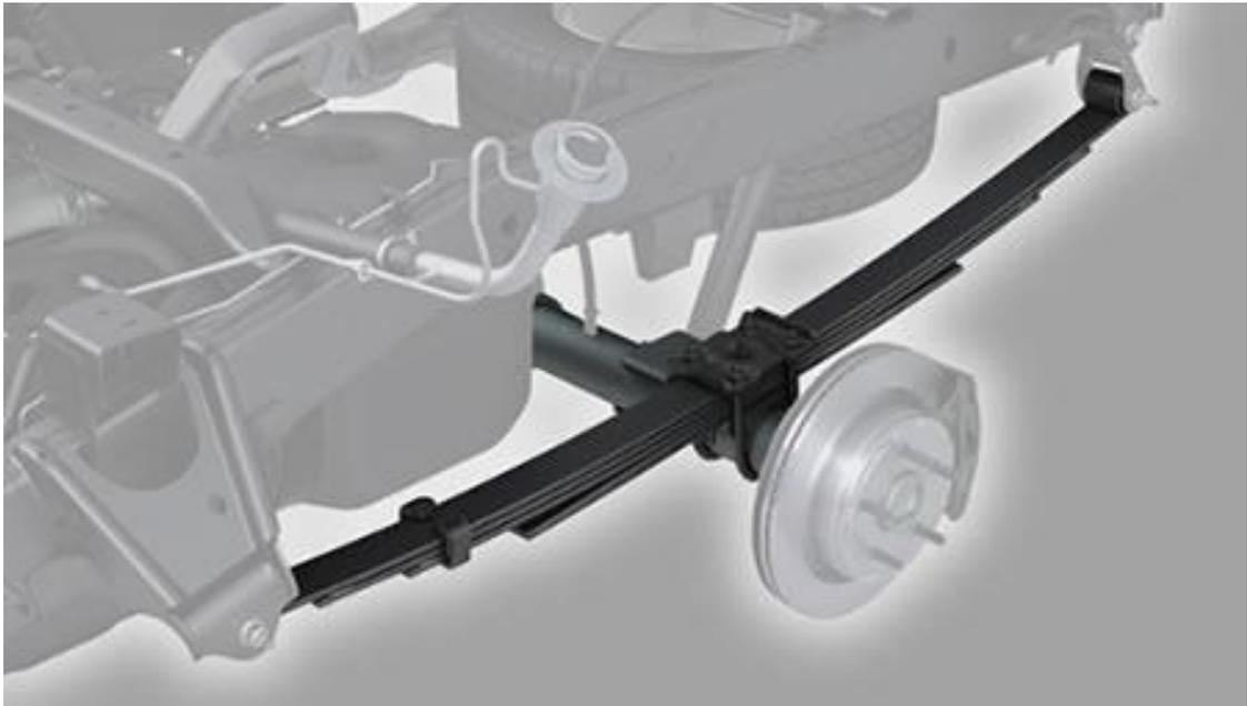
**Figura 1.5.** Ballesta instalada sobre el eje posterior.
