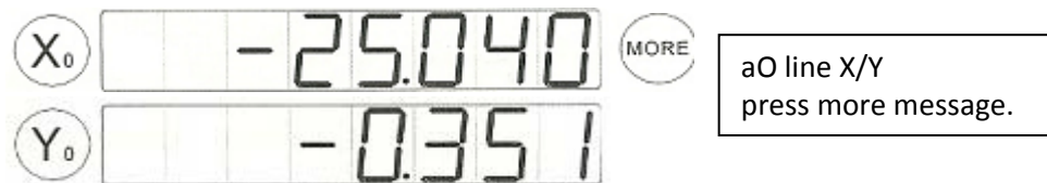
Figura 2-21 Mensaje de medición de línea.
