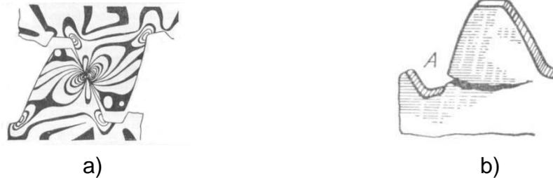
Figura 2 a) Modelo Físico de engranajes de material traslúcido para la visualización del estado tensional por el método óptico polarizado. b) Propagación transversal de una grieta provocando la fractura por fatiga.
