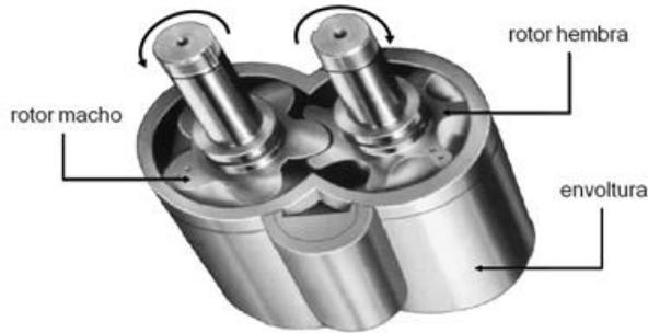
Figura 1.2 Compresor de tornillo
