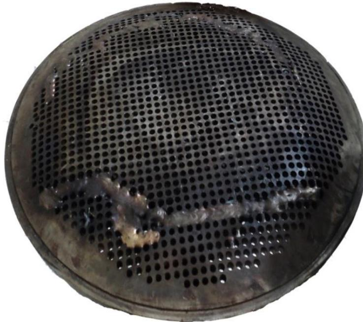
**Figura 1.9: Plato perforado de la Bomba Máster MP 2C120, posición de las grietas y los cordones de soldadura durante su reparación.**
