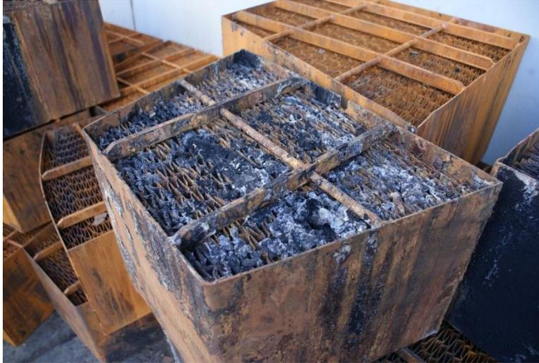
**Figura 1.7: Cesto del CAR deteriorados. Fuente: CTE CMC.**
