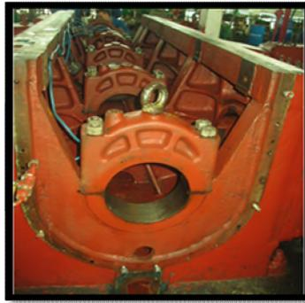
Fig. 10 Carter o Armazón donde se alojan los metales de punto de apoyos, el cigüeñal y las bielas.
