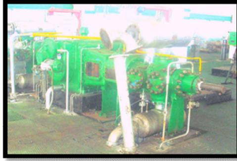
Fig. 6 Compresor balanceado opuesto.
