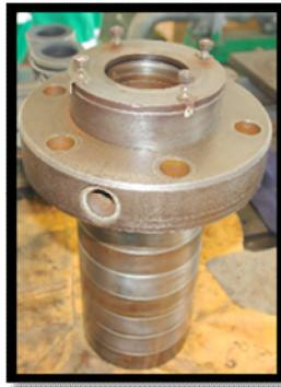
Fig.19. Bloque de sellos. Es el conjunto de cajuelas que protege y aloja a los elementos de sellos en la cavidad del cilindro.
