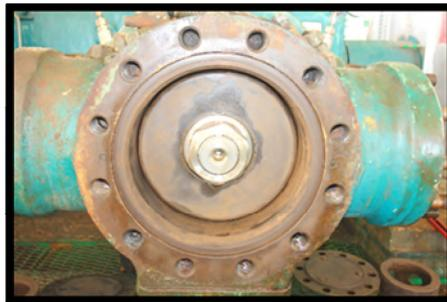
**Fig.13 Conjunto cilindro-pistón para realizar las mediciones y detectar el desgaste de los aros guías sin realizar un desarme mayor.**
