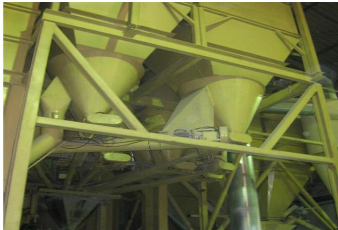
Figura 2.9: Celdas de dosificación.
