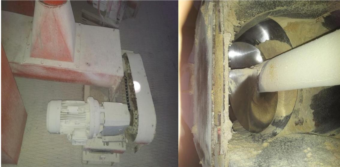
Figura 2.3 Transportador por tornillo sinfín
