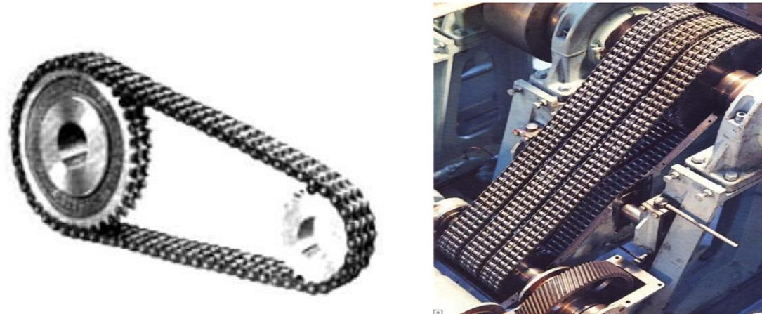
Figura 1.6 Ejemplo de transmisiones por cadena
