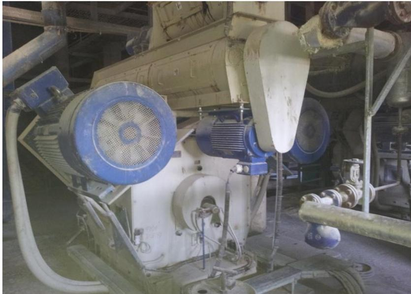
Figura 2.13: Prensa productora de pellets.
