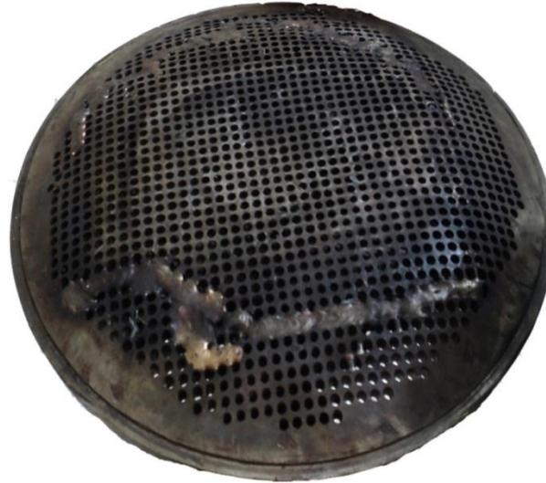
**Figura 1.14 Plato perforado Bomba Master MP 2C120 y posición de las grietas y los cordones de soldadura durante su reparación**
