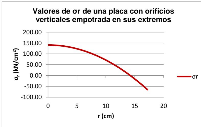
Figura 2.22 Valores de  $\sigma_r$  de una placa con orificios verticales empotrada en sus extremos. Fuente: Elaboración propia
