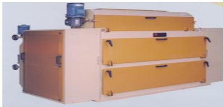
Figura 2.1. Molino de rodillos
