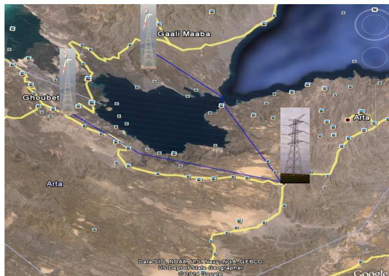
Fig.3.14. Conexión eléctrica de los dos parques eólicos a la red. Variante 2. (Fuente: Google Earth)
