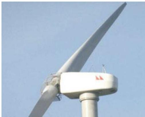
Fig. 1.7. Aerogenerador bipala. (Fuente: Nordic)
