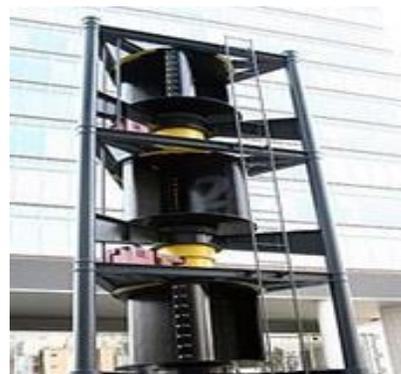
Fig. 1.5. Turbina Savonius.
