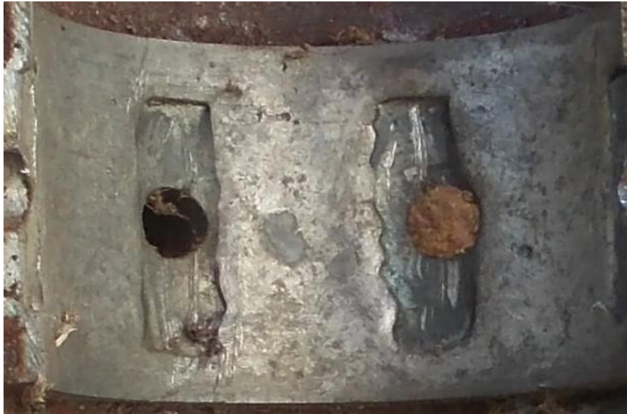
Figura 2.7 Falla encontrada en los cojinetes.
