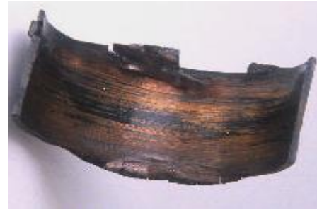
Figura 1.13 Desgaste adhesivo severo, conocido como gripado.
