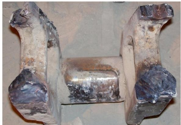
Figura. 1 Vista de las grandes piedras en la cantera y de la fractura de los eslabones del TP1
