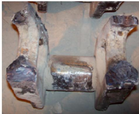
Figura. 2.4: Vista de la sección del eslabón en la zona de fractura
