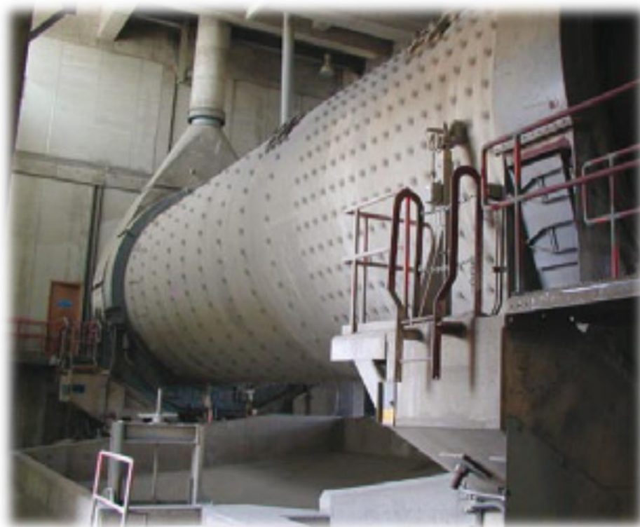
Figura 1.3 Dosificación y molienda de crudo.
