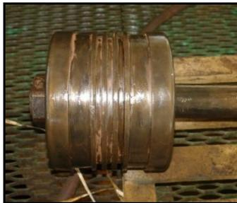
**Figura 2.6:** Pistón desgastado por deslizamiento
