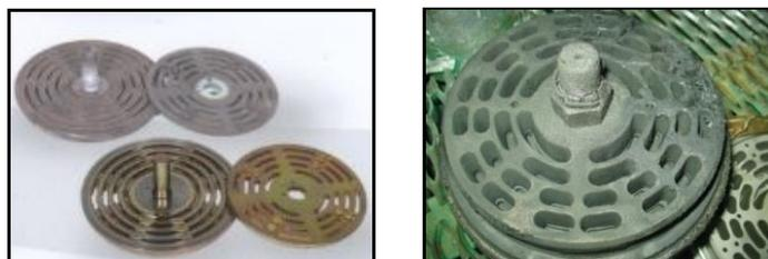
**Figura 2.2:** Válvulas de descarga
