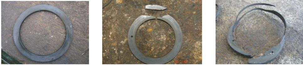
**Figura 2.5:** Muestra de empaquetaduras deterioradas
