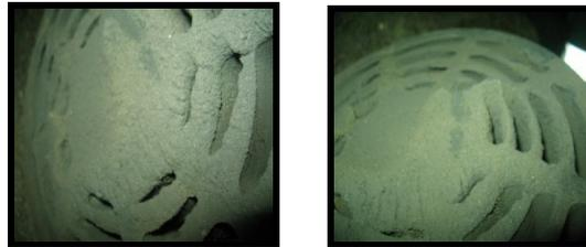
**Figura 2.3:** Válvulas deterioradas por el contacto con el hidrógeno
