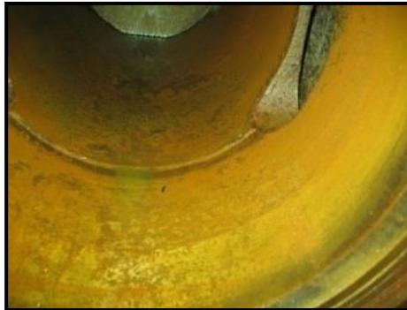
**Figura 2.12:** Muestra de una camisa deteriorada
