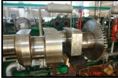
**Figura 2.9:** Cigüeñal y otros componentes del compresor
