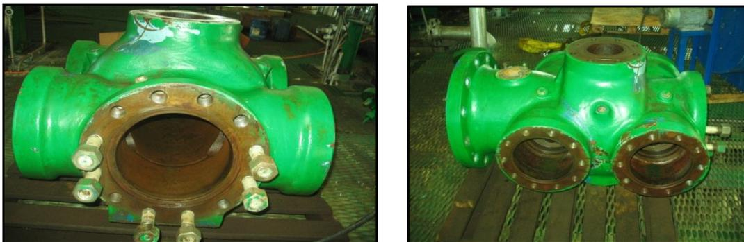
**Figura 1.8:** Cabezal con cavidades para la línea de succión, descarga y 2 válvulas de succión y 2 de descarga
