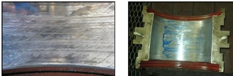
**Figura 2.8:** Defecto del metal babbit en chumacera del motor eléctrico
