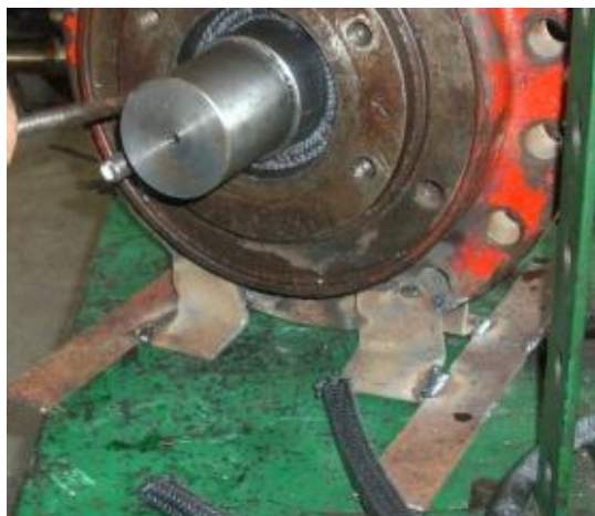
Figura 3.5 Vista de los angulares soldados al conjunto estopero-empaquetadura-eje
