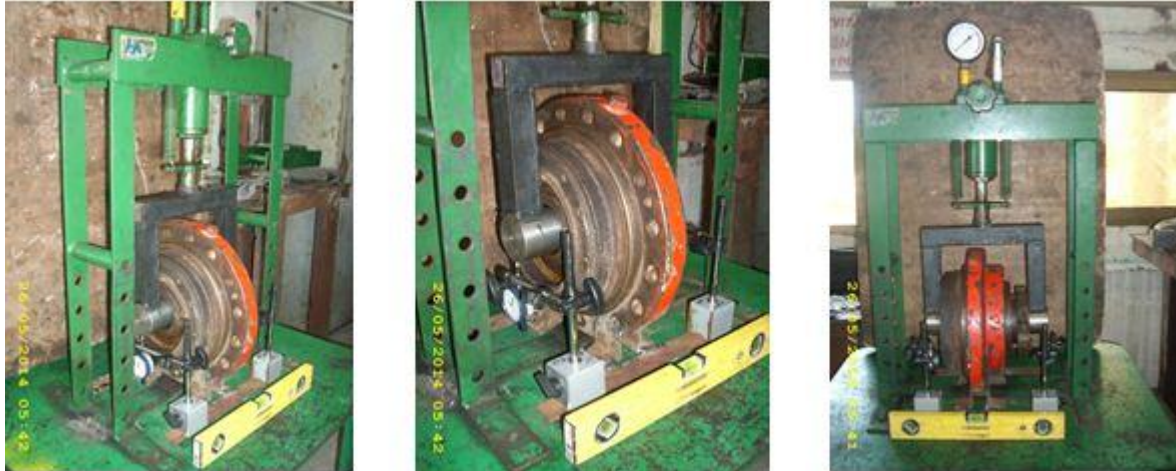
Figura 3.6 Montaje del conjunto estopero-empaquetadura-eje en la prensa con el dispositivo tipo puente
