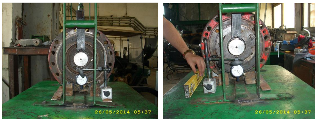
Figura 3.7 Vista lateral de la instalación de los Comparadores de Carátula de la instalación de los Comparadores de Carátula
