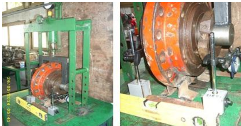
Figura 3.8 Vista de la instalación y de los comparadores de carátula
