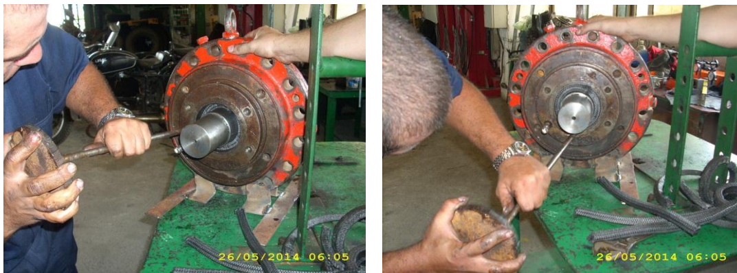
Figura 3.4 Proceso de montaje de las empaquetaduras en el estopero
