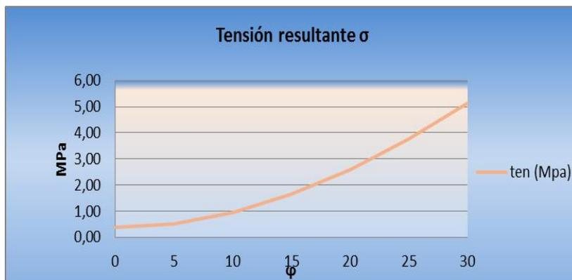
Gráfica 3. Comportamiento de la tensión  $\sigma$  en la llanta, según la variación del ángulo  $\varphi$ , la fuerza N y el momento flector M.
