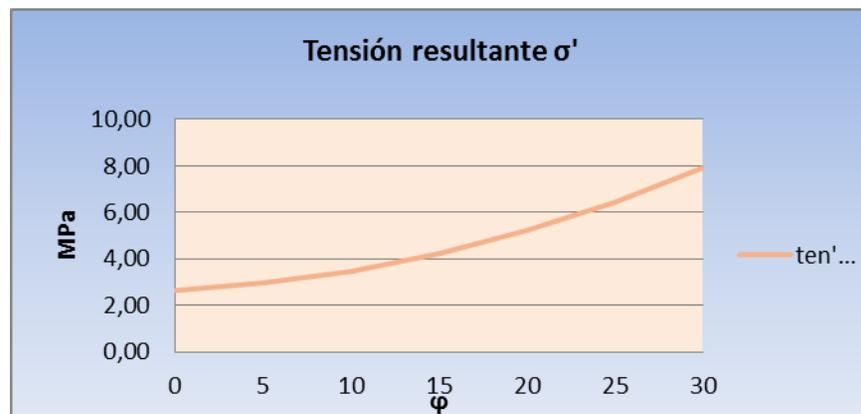
Gráfica 2. Comportamiento de la tensión  $\sigma'$  según la variación del ángulo  $\phi$
