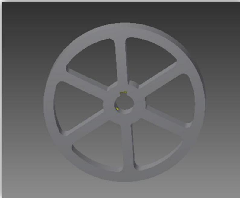
**Fig.2.3 Esquema del volante de rayos rectos.**
