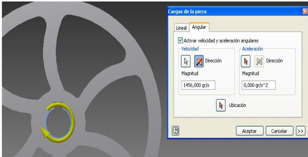
Fig. 3.8 Valor y ubicación de la velocidad angular introducida.
