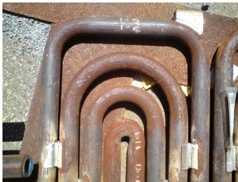
**Figura 3.2 Codos que fueron medidos del sobrecalentador secundario.**
