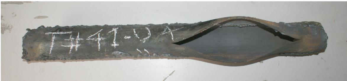
**Figura 3.52 Falla por creep donde la corrosión existente en el tubo tiene que haber incidido significativamente.**
