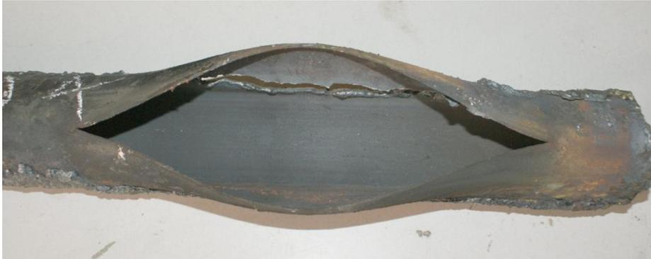
**Figura 3.37 Extensión de la zona plástica en una falla típica por creep o por colapsación plástica.**
