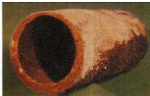
**Figura 1.9 Corrosión provocada por los gases de combustión.**
