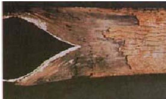
**Figura 3.34 Falla por creep donde la corrosión existente en el tubo tiene que haber incidido significativamente.**
