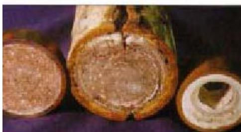
**Figura 1.4 Depósito en el interior de tubos de calderas**
