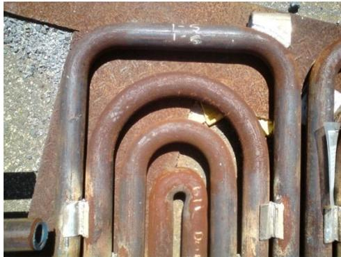
**Figura 3.2 Codos que fueron medidos del sobrecalentador secundario.**
