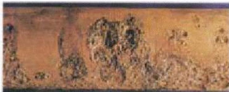
**Figura 1.7 Corrosión provocada por exceso de oxígeno en la caldera**
