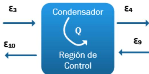
Figura 2-5. Procesos de transferencia de calor dentro de un condensador
