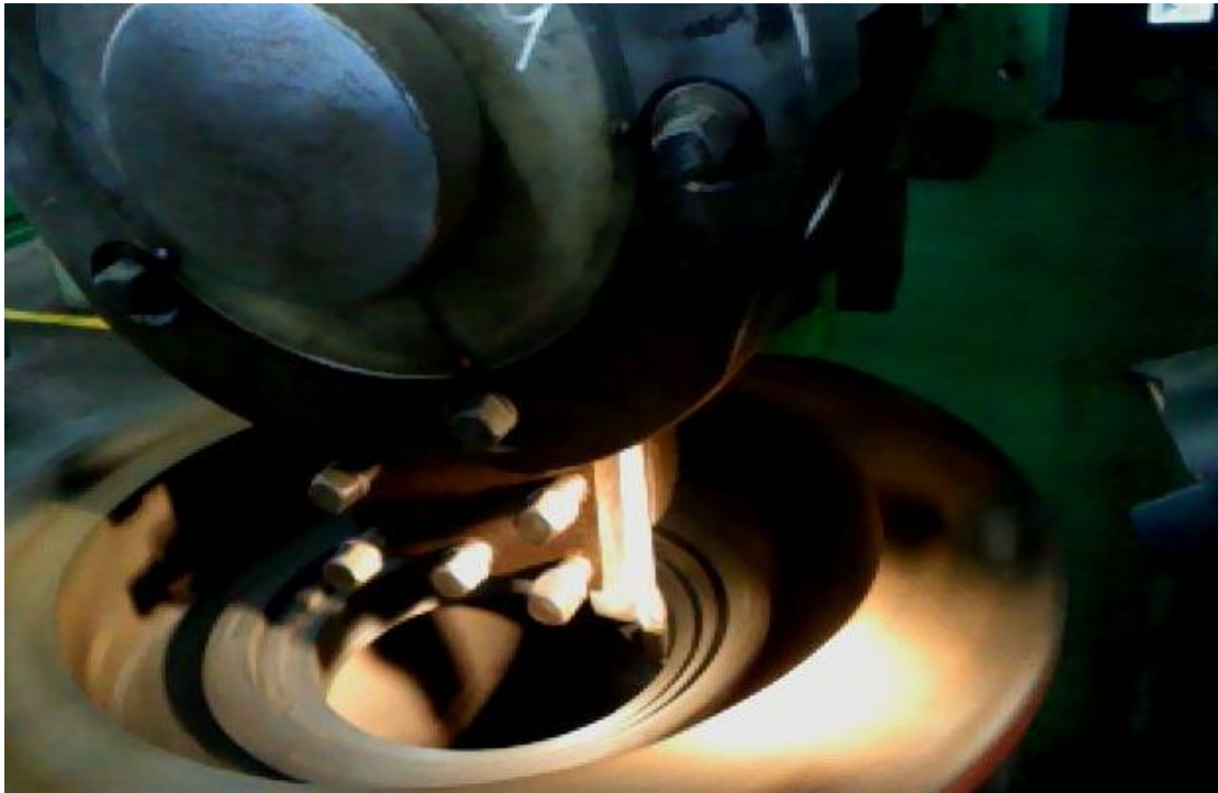
Fig. 2.10 Maquinado en el interior del carter.
