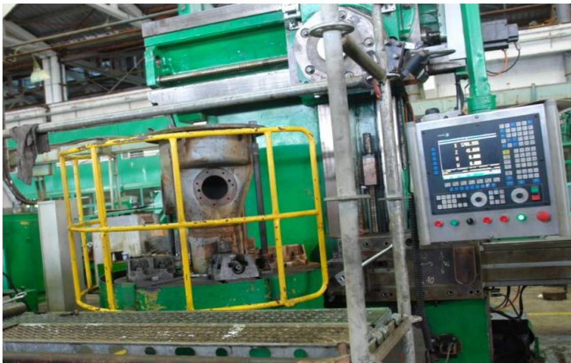
Fig. 2.8 Montaje y sujeción del carter del reductor en el torno vertical CNC.
