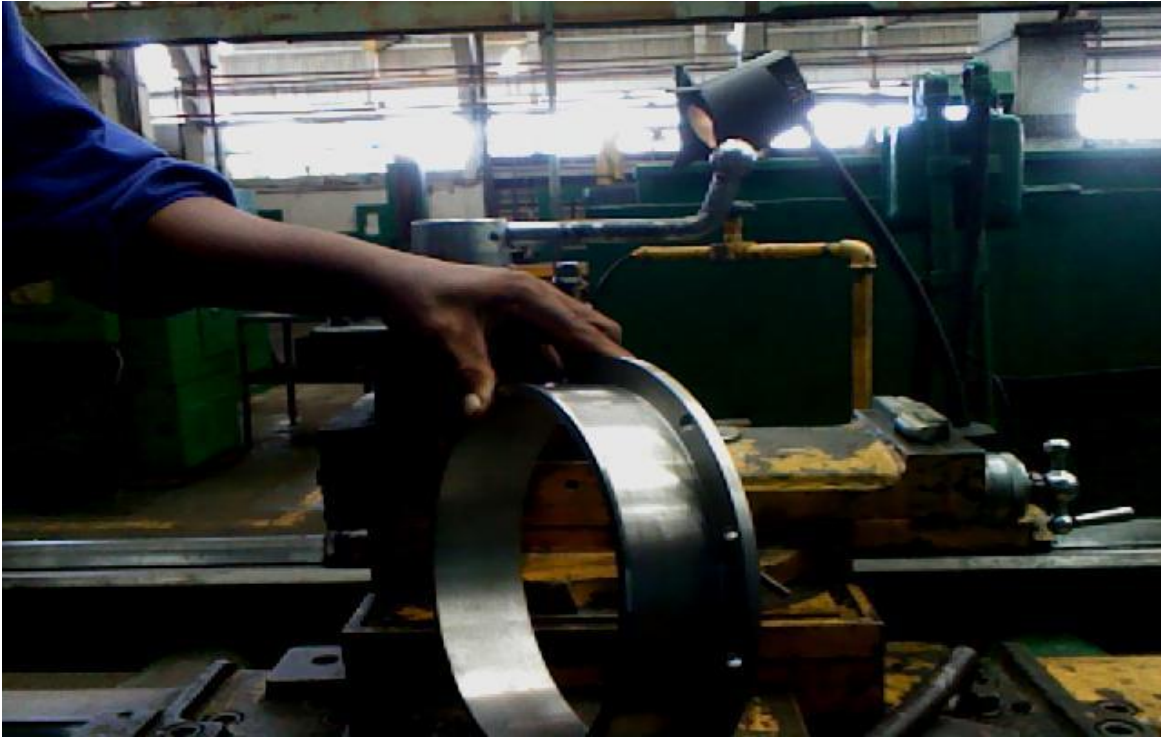
Fig. 2.16 Obtención del casquillo intercambiable después del rectificado interior.
