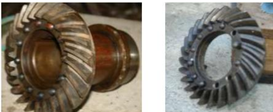
Fig. 1.8 Sujeción de la corona en la camisa.
