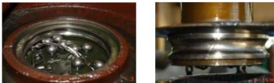
Fig. 1.10 Fractura de la caja de bola radial de simple hilera inferior.
