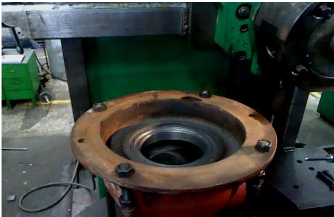
Fig. 2.9 Vista superior del carter. Posición de los tensores.
