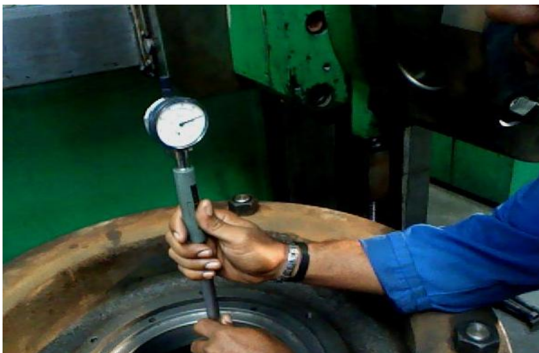
Fig. 2.11 Verificación del \varnothing 230 \text{ H5}(+0.02/0) donde queda instalado el casquillo intercambiable.
