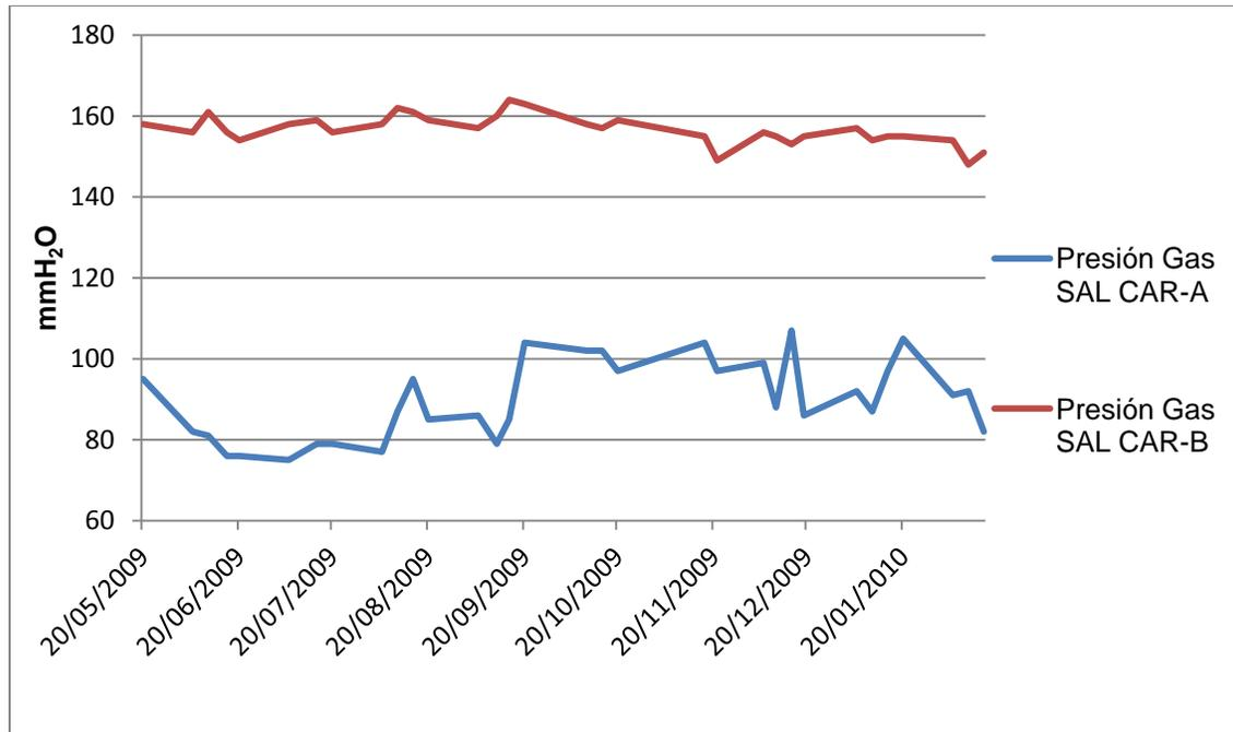
Figura 2.3 Comportamiento en el tiempo de la presión del gas en el C.A.R.
