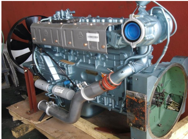
Figura 1.5 Foto del Motor Sinotruk que será instalado en la cuña Freightliner.
