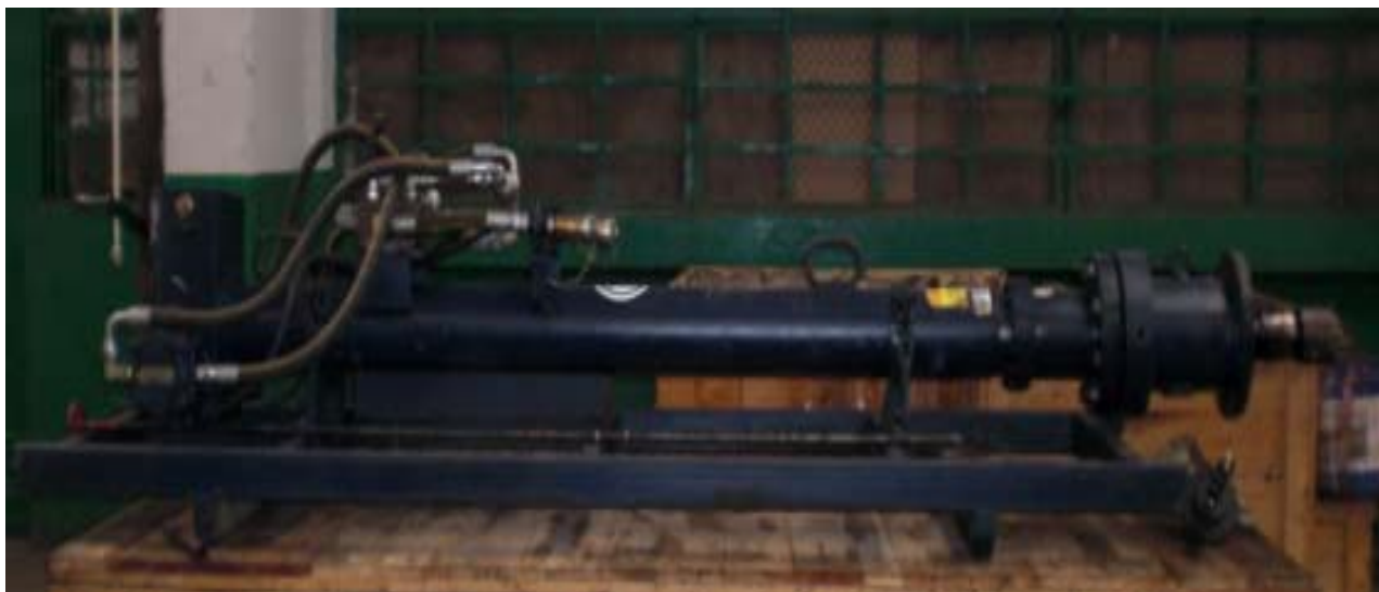
Fig.1.7 Hot Tap TBL-0664 perteneciente a la refinería de petróleo.
