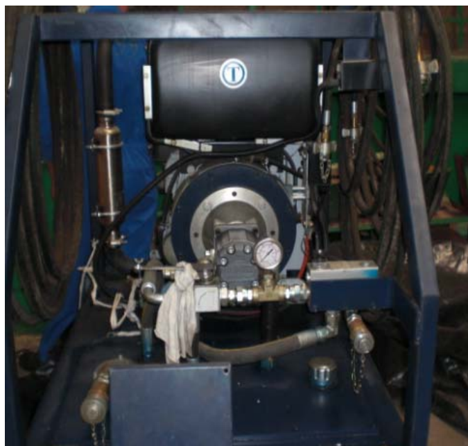
Fig.1.8 Generador de energía hidráulico HPP-0081.
