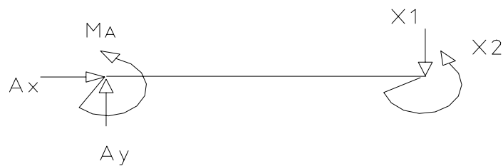
Figura 2.12 Esquema de análisis para la determinación de las reacciones del conjunto sobre apoyo delantero.
