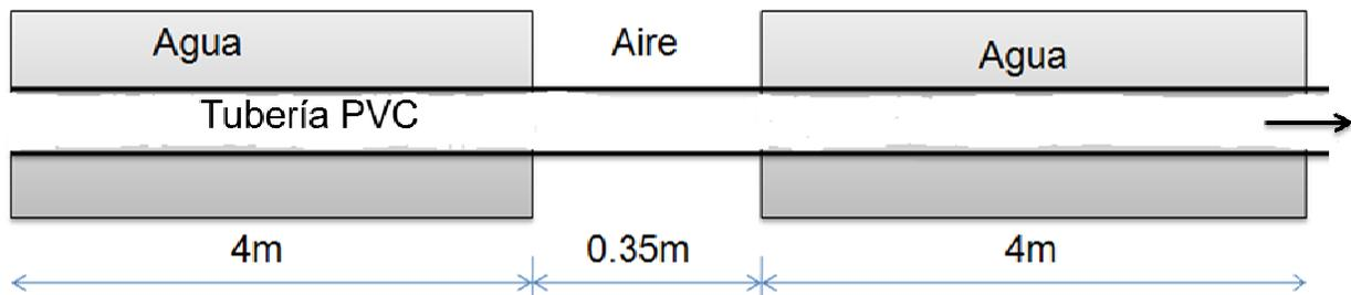
Figura 4.1. Proceso de Enfriamiento de tubería PVC
