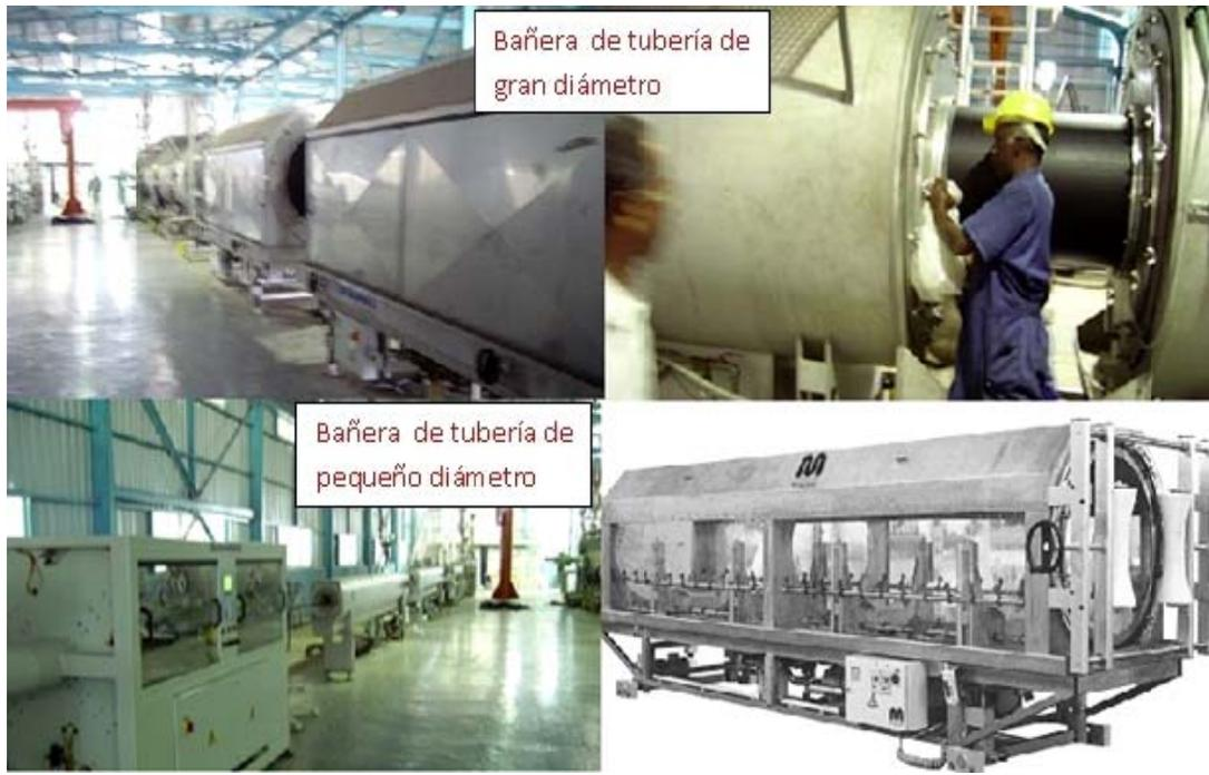
Figura.1.8.Bañera de enfriamiento de tubería PVC.
