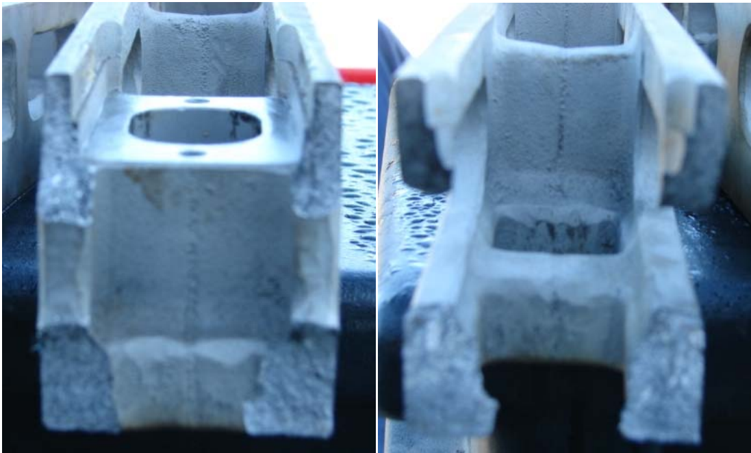
Foto 3. Fractura de la barra superior.
