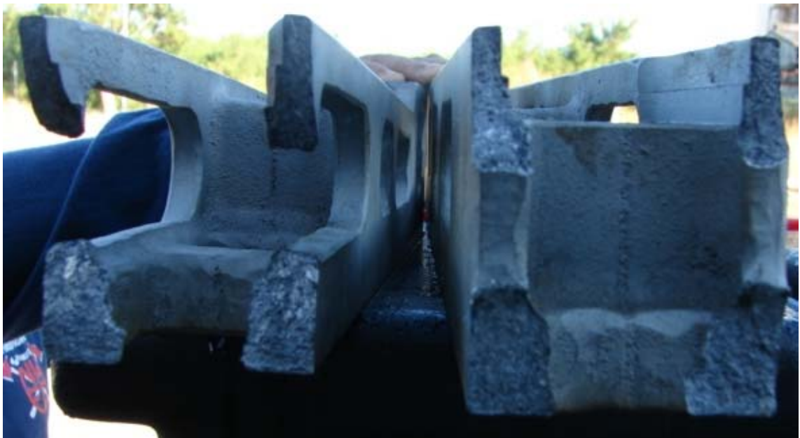
Foto 4. Fractura de la barra superior.
