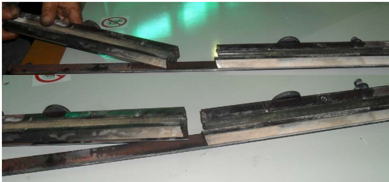
Foto 7. Fractura de la barra inferior.
