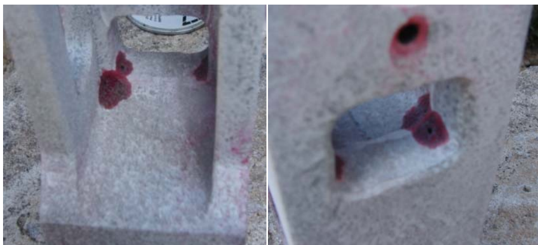
Fig. 1.17. Aplicación de líquidos penetrantes en la barra inferior.
