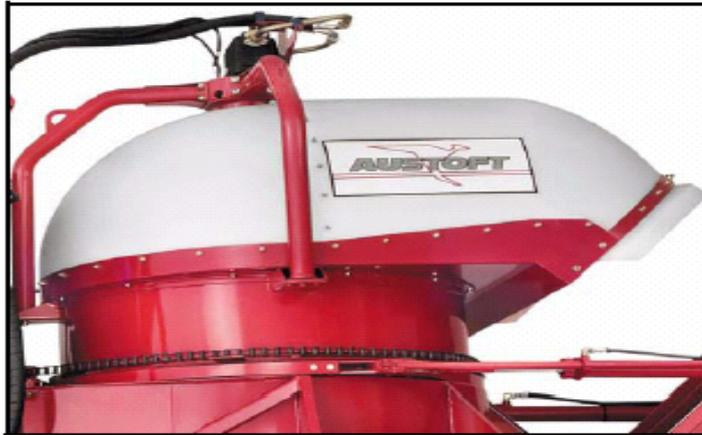
**Fig. 1.13 Gorro del Extractor Primario.**
