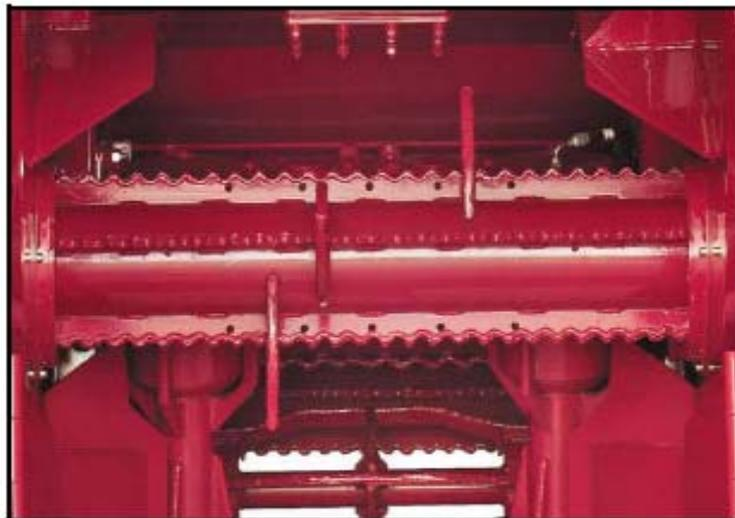
**Fig. 1.8 Rollo Alimentador.**
