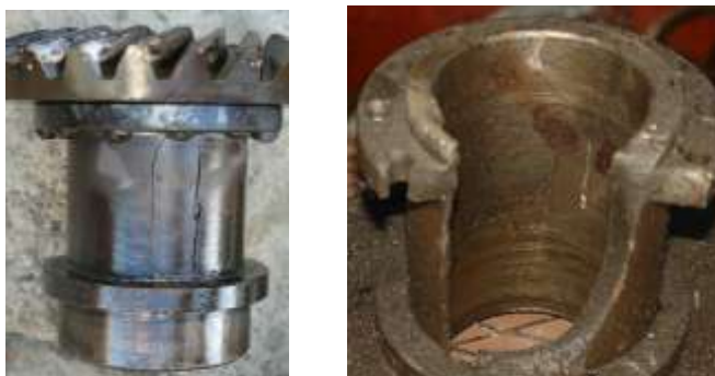
Fig. 1.9 Fractura del manguito en la zona del chavetero.
