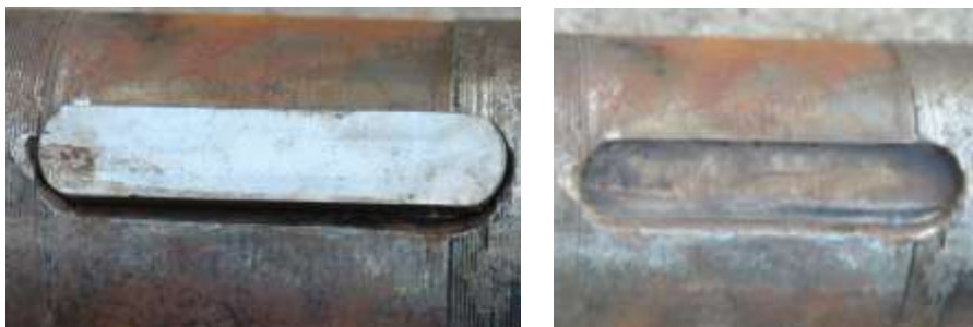
Fig. 1.8 Juego y aplastamiento entre chaveta y chavetero y encaje de la chaveta en su asiento.
