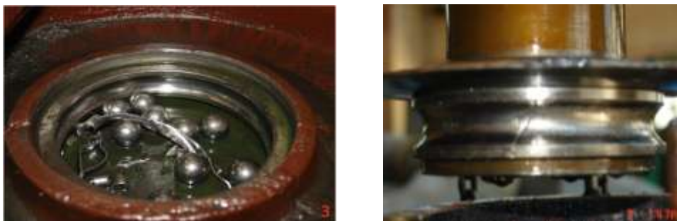
Fig. 1.10 Fractura de la caja de bolas radial de simple hilera inferior.
