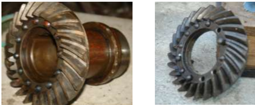
Fig. 1.7 Corona montada en la camisa con remaches y corona en la cual se han partido los remaches.
