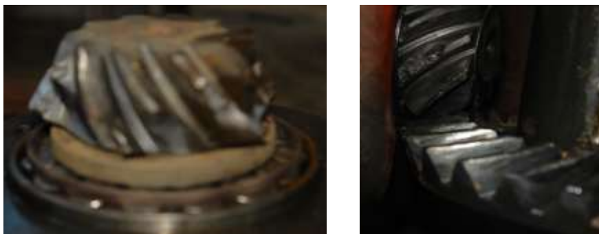
Fig. 1.6 Vistas de Fracturas de los Dientes del Piñón.
