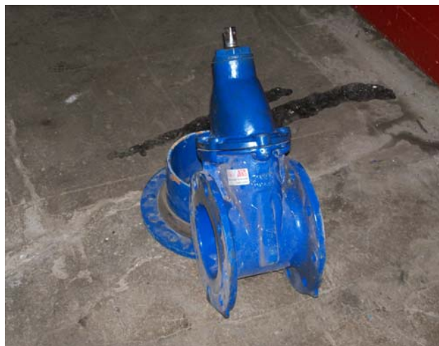
Figura 1.4 Válvulas de compuerta de retención.
