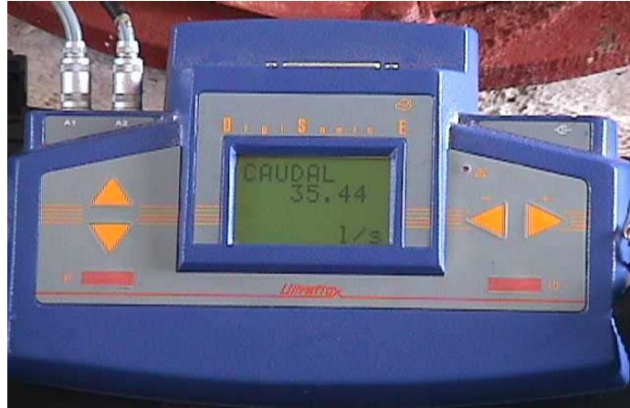
Fig. 1.5 Equipo para la medición del caudal con el medidor ultra flux.
