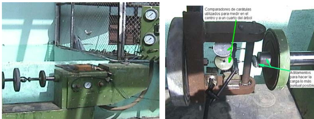
Fig. 1.11 Instalación Experimental. a) Prensa Neumática b) Medición de las flechas
