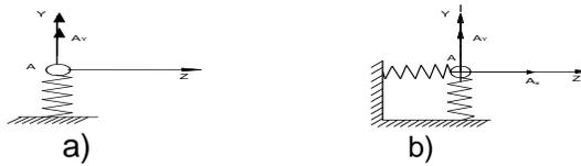
Figura 2.17: Esquema de análisis del apoyo articulado: a) Móvil elástico y b) Móvil fijo. Fuente: (Goytisoló, 2006).
