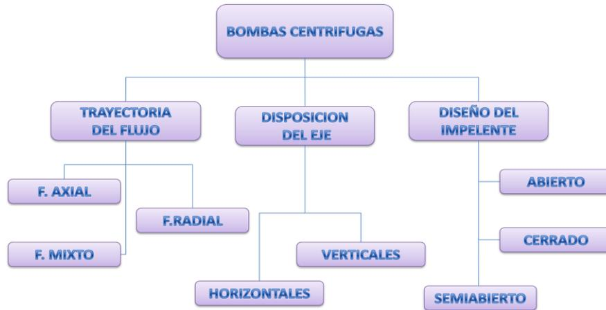
Figura 1.2: Clasificación de las bombas centrífugas. Fuente: (Elaboración propia).
