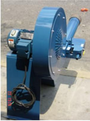
Con llaves para el control del flujo de gas y del aire; con cañón de 4" de diámetro y cabezal de hierro fundido de 5" de diámetro exterior.
