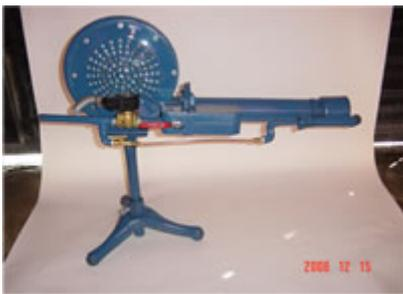
Con motor de  $\frac{1}{4}$  HP. 3 450 rev/min. Monofásico, con un consumo máximo de gas de 25 L/h, con una potencia calorífica de 1 000 000 BTU.
