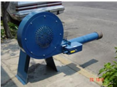
Con motor de 2 HP de 3 450 rev/min Trifásico, con un consumo de gas de 85 L/h, una capacidad térmica de **4 300 000 BTU.**
