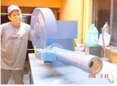
Con motor de 5 H. P. de 3 500 rev/min (o más según el fabricante), trifásico, con una capacidad de aire de la turbina de 3 400 m<sup>3</sup>/h. Con un consumo de gas de 190 L/h y una potencia máxima calorífica de **7 500 000 B.T.U.**
