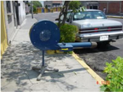
Con un consumo de combustible de 95 L/h, una capacidad térmica de **5 600 000 BTU**. Con llaves para el control del flujo de gas y del aire; con cañón de 4" de diámetro, cabezal de hierro fundido de 5" de diámetro exterior.
