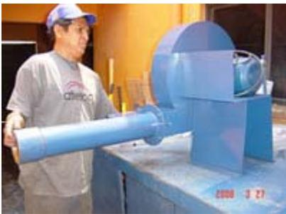
Con llaves para el control del flujo de gas y del aire; lo que facilita la regulación de la potencia del mismo), con cañón de 4" de diámetro y cabezal de hierro fundido de 5" de diámetro exterior; con un largo total aproximado de 1.32 m.
