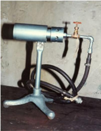
Fabricado en tubular de acero calibre 40, de 2" de diámetro por 35 cm de largo, con control de flujo del aire para un mejor funcionamiento, y con llave para control de flujo de gas y pedestal.
