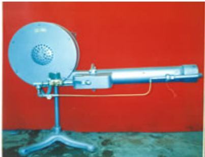
Con motor de 3 HP, Trifásico, de 3,450 rev/min, con un consumo de gas de 68 L/h, una capacidad térmica de **5 600 000 BTU**.
