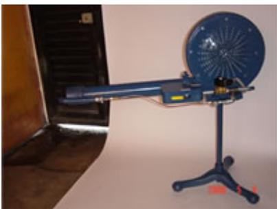
Con motor de 1 HP 3 500 rev/min (o más según el fabricante), monofásico, con una capacidad de aire de la turbina de 1000 m<sup>3</sup>/h, con un consumo máximo de gas de 85 L/h con una potencia máxima calorífica de **2 930 000 BTU**.
