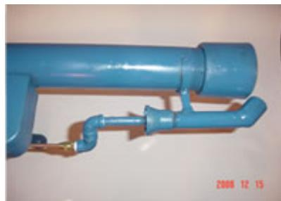
Con llaves para el control del flujo de gas y del aire; con cañón de 2  $\frac{1}{2}$ " de diámetro y cabezal de fierro fundido de 3  $\frac{1}{2}$ " de diámetro exterior.
