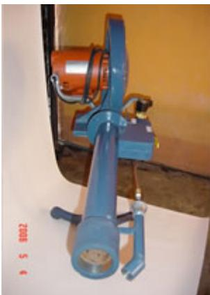
Con llaves para el control del flujo de gas y del aire (lo que facilita la regulación de la potencia del mismo); con cañón de 3" de diámetro y cabezal de fierro fundido de 4.5 " de diámetro exterior, con un largo total aproximado de 1.20 m.
