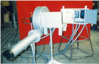
Con un consumo de diesel de 80 L/h, una capacidad térmica de **5'600,000 BTU**, con llaves para el control del flujo de diesel y del aire; con cañón de 4" de diámetro y cabezal de Acero de 5" de diámetro exterior.
