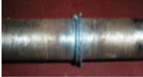
Figura 3.7 Unión mediante soldadura por fricción de probetas de tal material.
