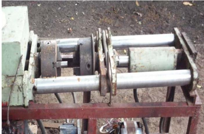
Figura. 3.7 – Carro móvil sobre la bancada
