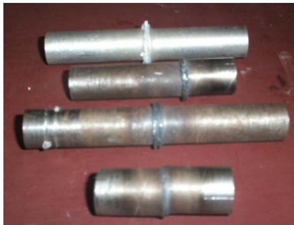
Figura 3.2 Unión mediante soldadura por fricción de probetas de tal material
