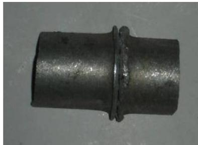
Figura 3.10 Características del corte transversal de la unión soldada.
