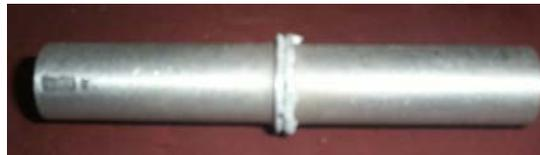
Figura 3.3 Unión mediante soldadura por fricción de probetas de tal material
