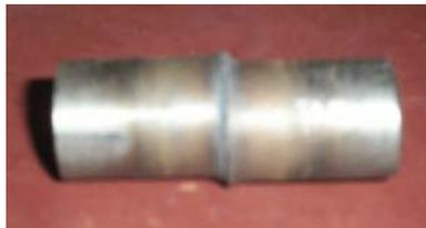
Figura 3.5 Unión mediante soldadura por fricción de probetas de tal material.
