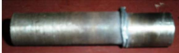
Figura 3.9 Unión mediante soldadura por fricción de probetas de tal material.
