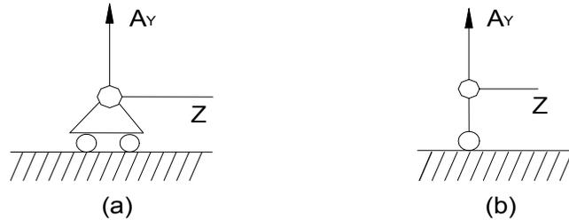
Fig. 2.3 Modelo Físico del Apoyo Articulado Rígido Móvil
