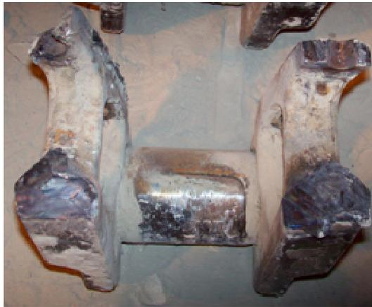
Fig. 3.4 Vista de la Sección del Eslabón en la zona de Fractura
