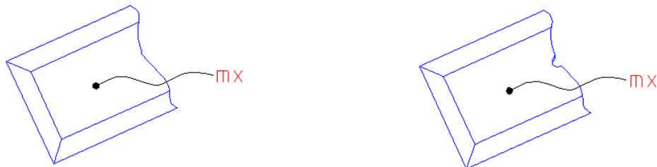
Fig. 3.7 Masa ( $m_x$ ) con soldadura y con agujero.
