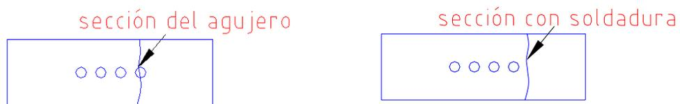
Fig. 3.8 a y b Secciones a analizar, tanto con agujero como con soldadura.
