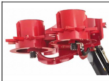
Fig. 1.3 Cortador de Puntas.
