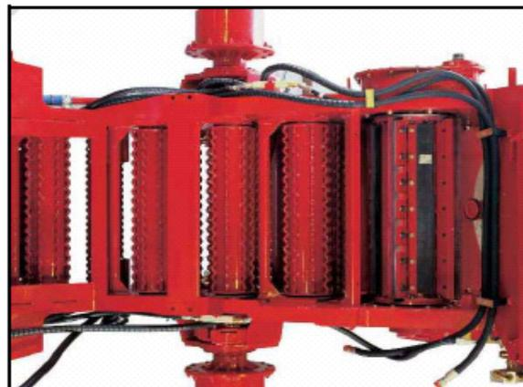
Fig. 1.11 Conjunto de Rollos Alimentadores (Tren de Rollos).
