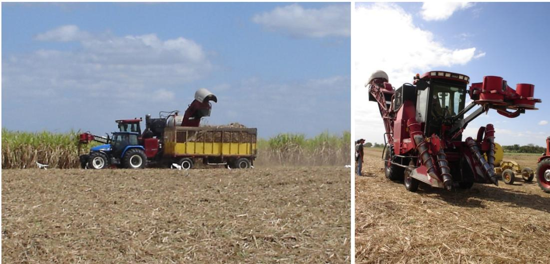
Fig. 2.1 Cosechadora de caña Case A7000 realizando su trabajo.
