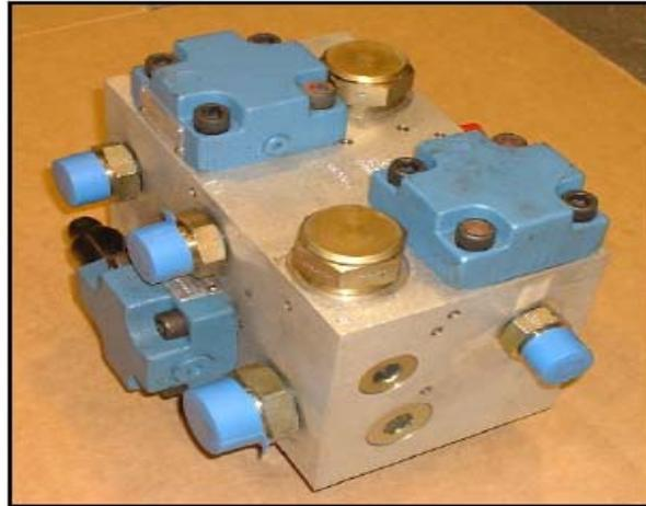
Fig. 1.40 Imagen del bloque del picador.
