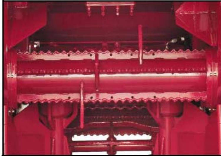
Fig. 1.9 Rollo Alimentador.
