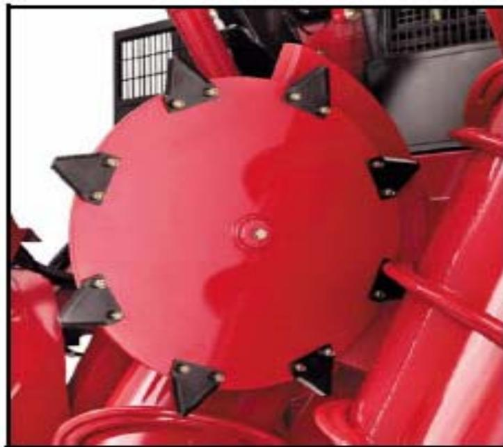
Fig. 1.6 Discos de Corte Lateral (OPC).
