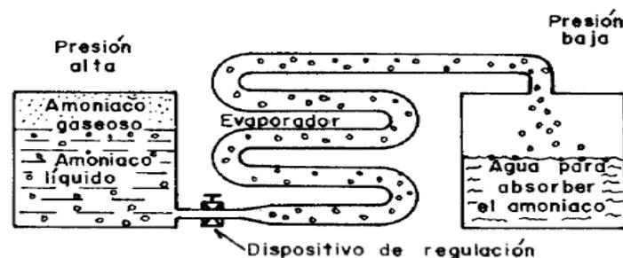
**Figura 3. Absorción del amoníaco en una solución amoníaco - agua**
