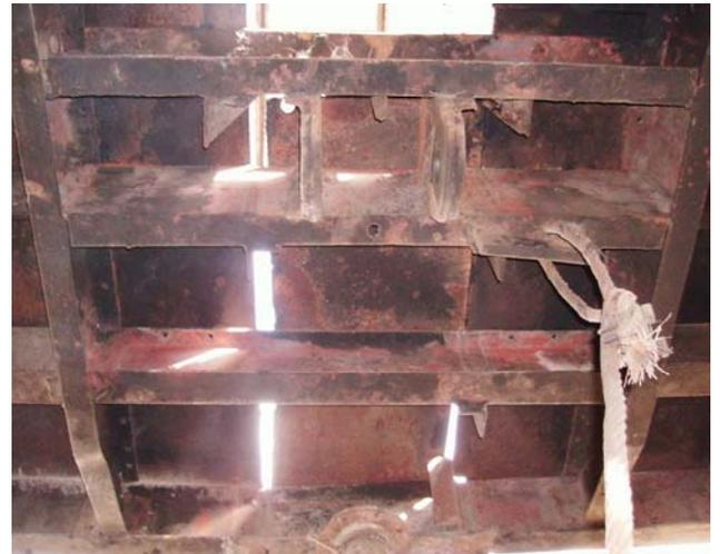
**Figura 2.1 Representación de la estructura de soporte de la plataforma del virador o basculante.**
