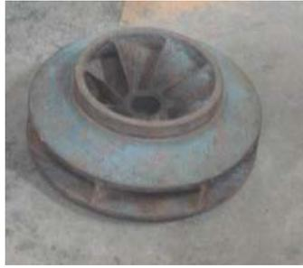
Figura 2.2: Impelente de una bomba centrífuga radial.
