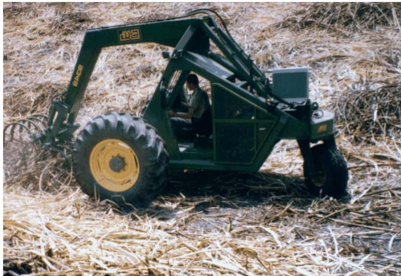
**Fig. 3.1 Vista de la Alzadora de Caña BMH - II.**
