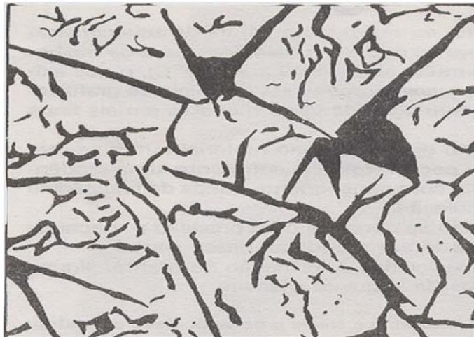
**Fig. 3.3 Estructura Metalográfica del Hierro Fundido Gris de los Distribuidores**
