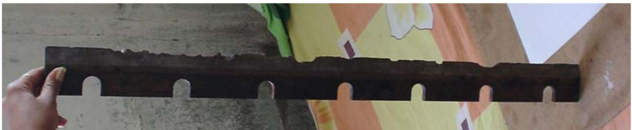
**Fig. 3.12 Vista de la cuchilla con el filo actual fracturado en distintas posiciones en la zona de  $h \leq 6$  mm.**
