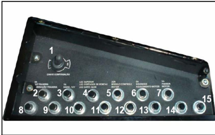
**Fig. 1.32 Imagen del mando del lado derecho – sección inferior.**
