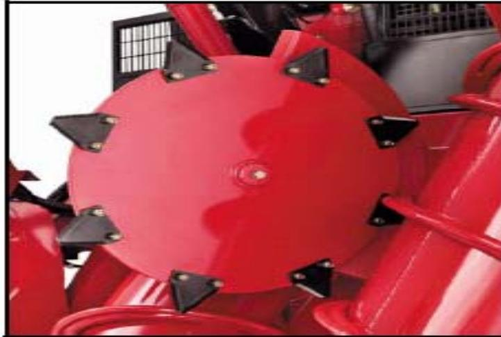
**Fig. 1.5 Discos de Corte Lateral (OPC).**
