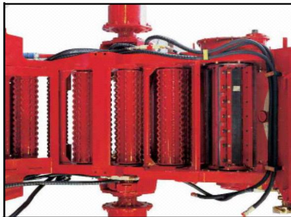
**Fig. 1.10 Conjunto de Rollos Alimentadores (Tren de Rollos).**
