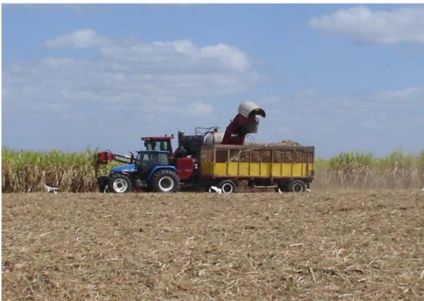
**Fig. 2.1 Cosechadora de caña Case A7000 cortando la caña de azúcar y descargándola en el remolque de un camión.**
