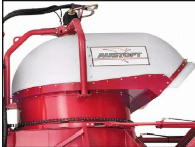
**Fig. 1.13 Gorro del Extractor Primario.**
