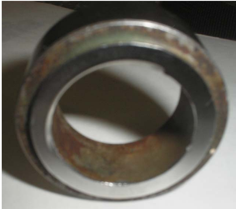
Fig. 3.3. Pieza fija de la válvula de seguridad.
