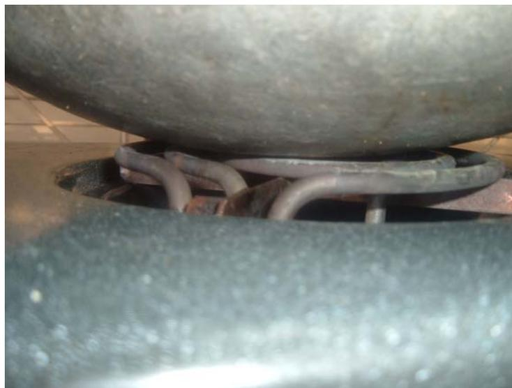
Fig. 3.1b Apoyo de la cazuela de fondo esférico sobre la hornilla
