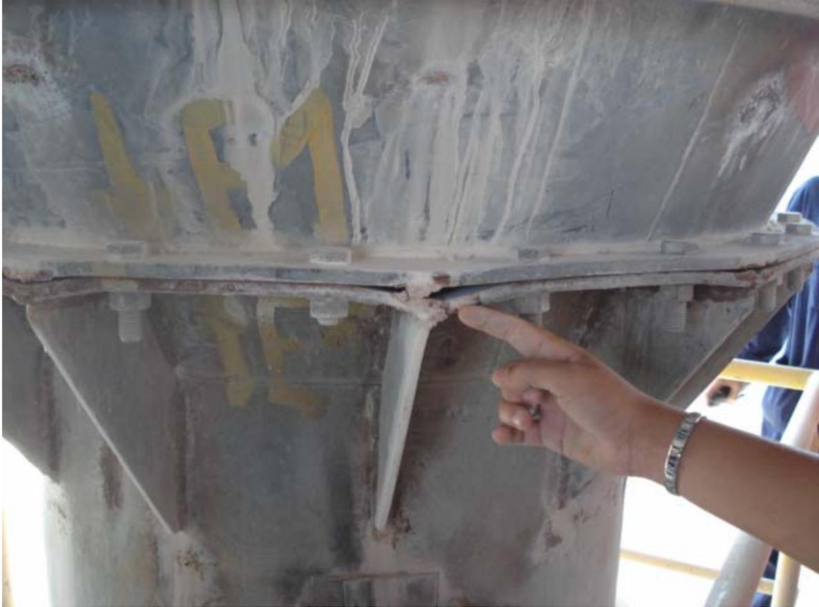
**Fig. 1.14 Deformación plástica y grietas observadas en la brida inferior del ciclón Z 12.**
