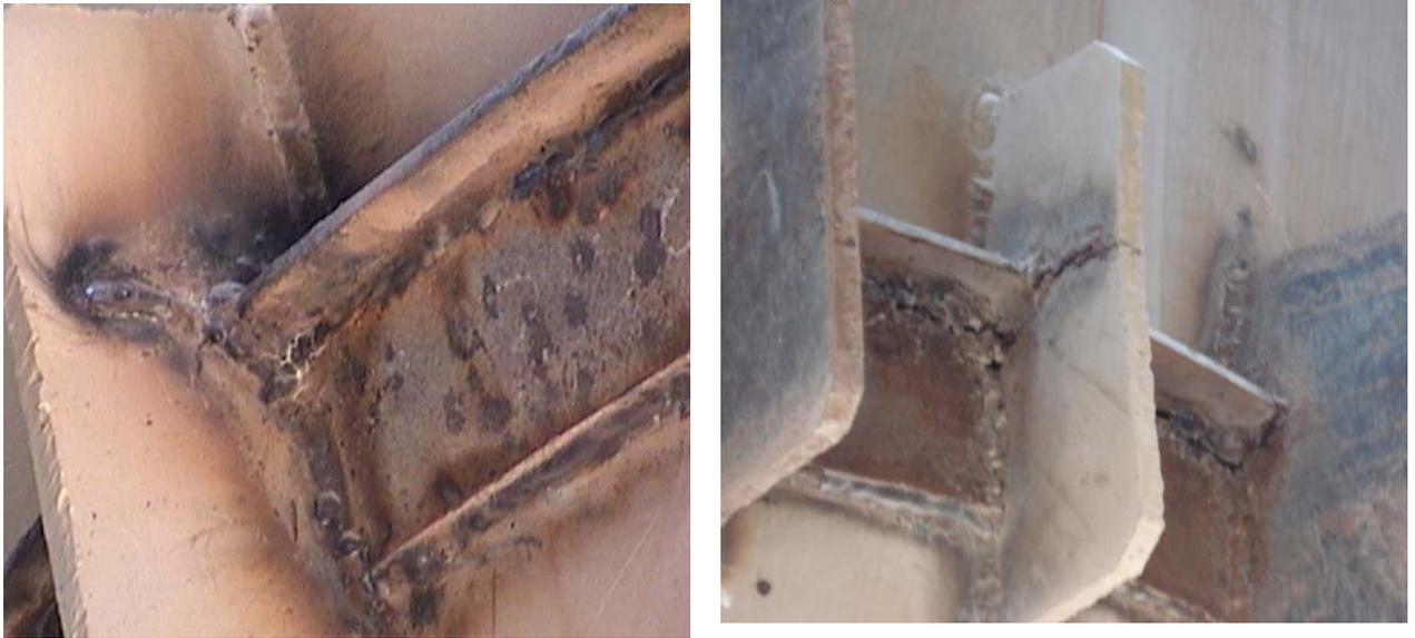
**Fig. 1.10 Refuerzos agrietados después de ser colocados**
