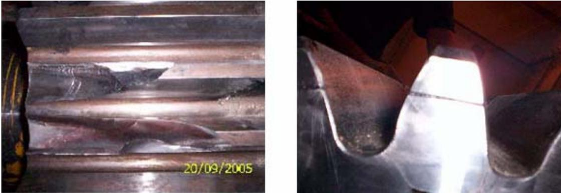
Fig. 1.13 Vista de los dientes fracturados y de grietas en otros dientes
