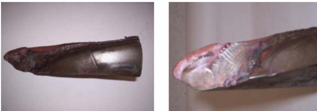
Fig. 1.12 Aspecto externo de las grietas de fatiga de los dientes.
