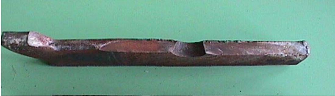
Fig. 2.6 Forma y proporciones de la grieta por fatiga en el momento de la fractura.
