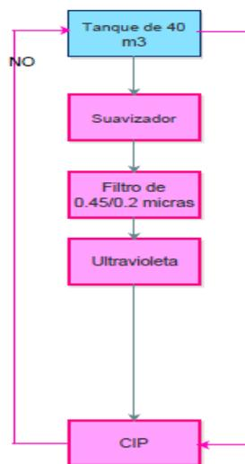
Diagrama de flujo del equipo CIP (Tanque de 40 m<sup>3</sup>).
